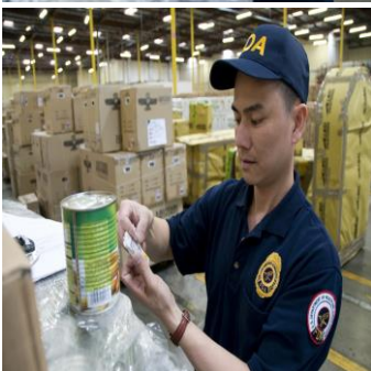
ในภาพเจ้าหน้าที่เจาะฝากระป๋องและจุ่มแผ่นกระดาษทดลองลงไปทีน้ำในกระป๋องก่อนนำมาเทียบสีกับตารางระบุคุณสมบัติทางเคมี
